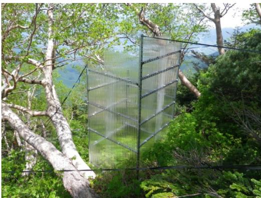
中央アルプスの森林限界に温暖化装置を設置し、生態系への影響を調べている
