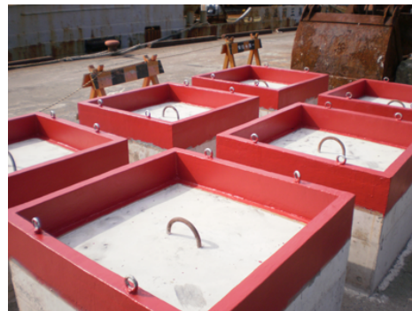
Figure 1: 海中囲い込み実験で用いたコンクリートブロック
