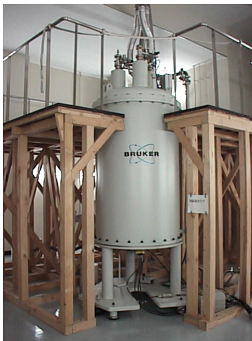
図1. 蛋白質の構造解析に使用する800MHz NMR装置。大きな超電導磁石であり、この中に蛋白質溶液を入れて解析する。蛋白質の中の位置によって磁場の感じ方が異なることを利用して、構造に關する情報を得る。
